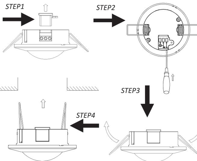
1. Spegnerne l'alimentatore principale e aprire il coperchio in plastica trasparente nella parte inferiore del sensore.
