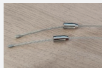
Прекарайте стоманените въжета през малките гилзи така, че стопера на въжетата да остане в тях.
